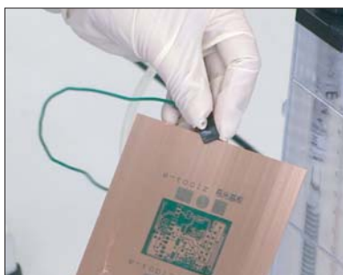
Pic.13 基板のふちにクリップを取り付けます。
