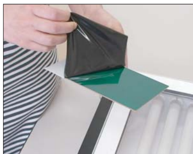
Pic.1 基板の保護フィルムをはがします。 感光面のレジストを傷つけないようにします。
