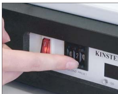
Pic.4 タイマーをセットします。 (露光時間はフィルムにより異なります。)
