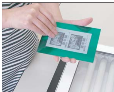
Pic.2 フィルムの印刷面と感光基板のレジスト面を合わせるように重ねます。
