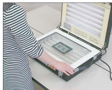
Pic.6 ブザーが鳴り、露光が停止したらスイッチを切り、基板を取り出します。
