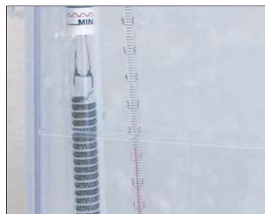
Pic.12 液温が45℃～50℃になるようにします。（60℃を超えないように）
