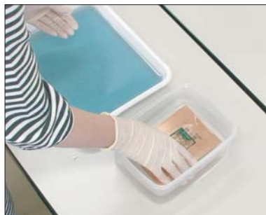
Pic.8 パターンがはっきり見えるようになったら取り出して水洗いします。
