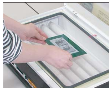
Pic.3 露光機にセットし、パキューム (真空引き) スイッチを入れ、密着させます。
