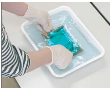
Pic.7 現像液に基板を入れ、静かにゆらしませす。
