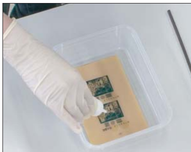
Pic.16 基板表面にフラックスを多めに塗ります。
