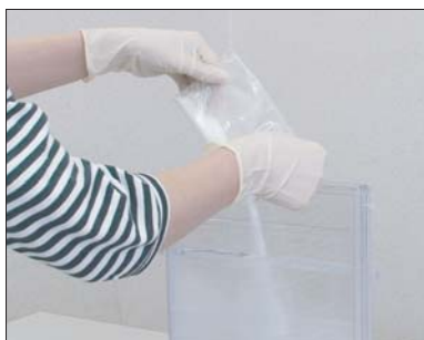
Pic.10 タンクに規定量の水とエッチング剤を入れます。
