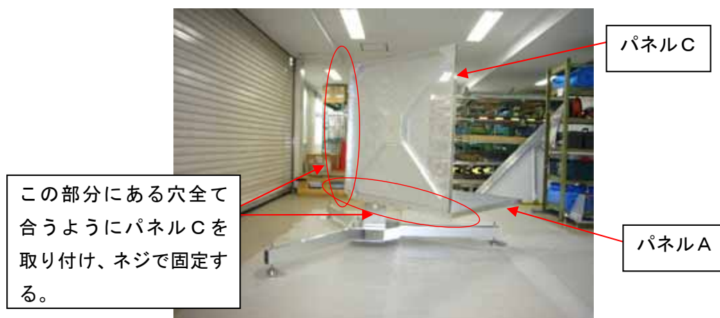
図3-4-2 パネルC取付（側面）
