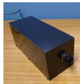
▲ エバ・ジャパン製ハイパースペクトルカメラ、SIS-H。画像サイズは640×480ピクセル、各ピクセルごとに可視光領域のスペクトルを約1000バンドに分割して記録。
