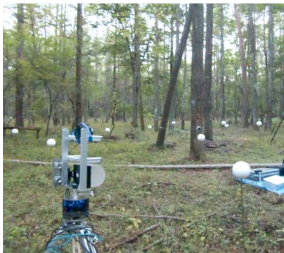
10月16日に計測した伐倒予定カラマツのレーザー計測の様子（左）と計測結果（右）
